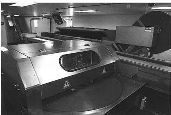
★ De vangstverwerkingsinstallatie van VCU met op de voorgrond de scholstripmachine van Leba.
